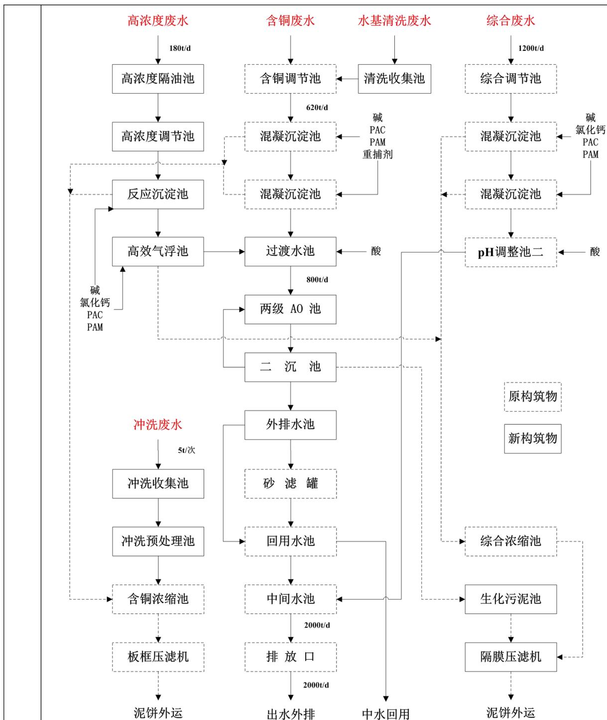
图4-3 厂区污水处理站工艺流程
