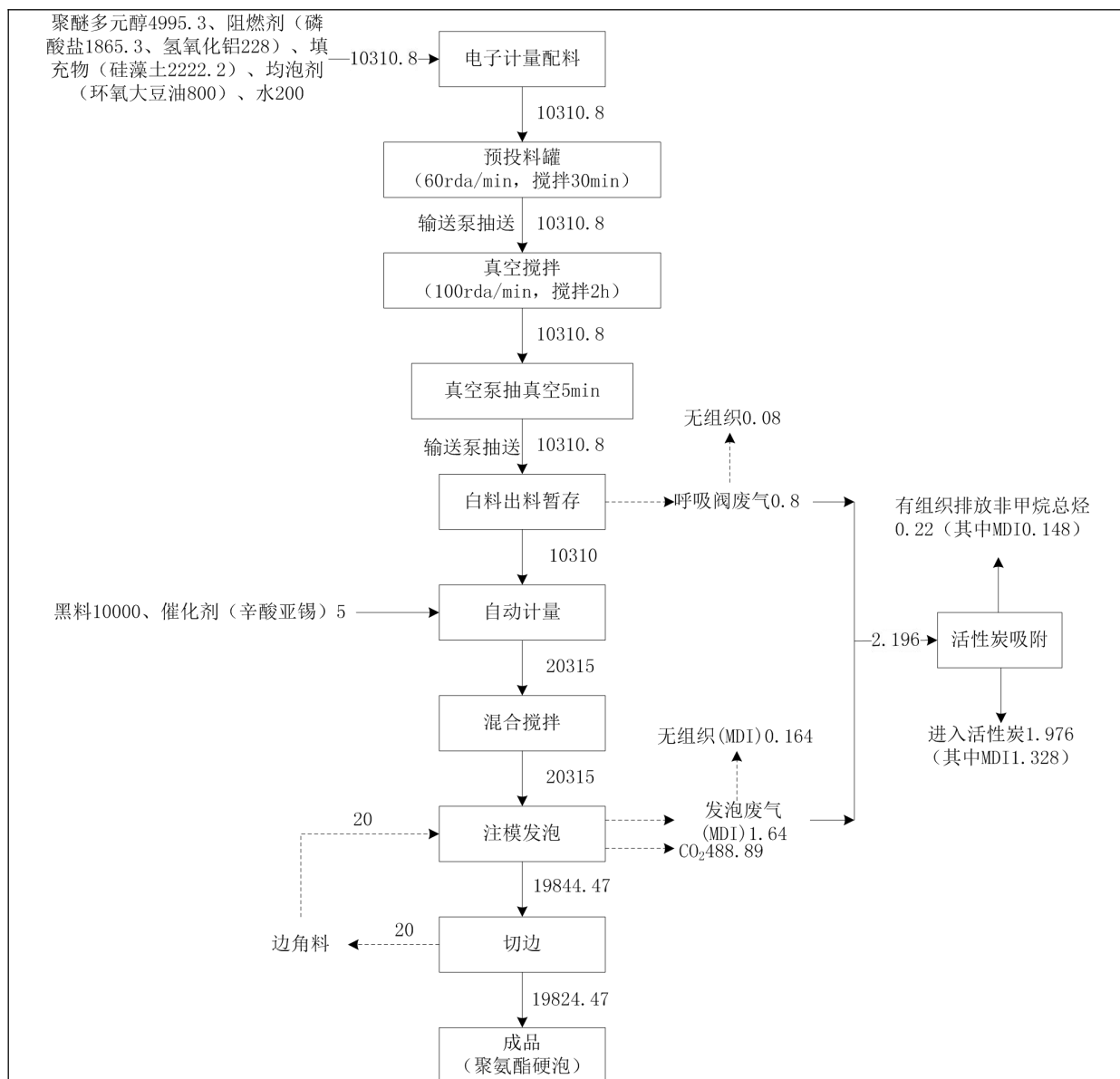
图 5-4 白料及聚氨酯硬泡物料平衡图 (t/a)
